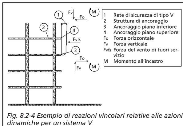
Fig. 8.2-4 Esempio di reazioni vincolari relative alle azioni dinamiche per un sistema V
