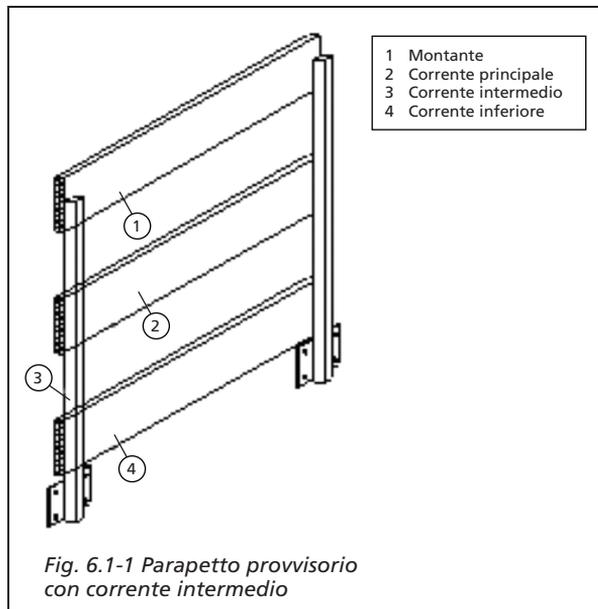
Fig. 6.1-1 Parapetto provvisorio con corrente intermedio
