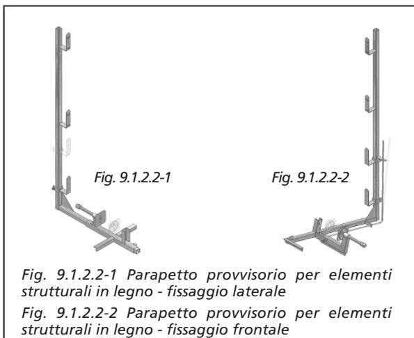
Fig. 9.1.2.2-1 Parapetto provvisorio per elementi strutturali in legno - fissaggio laterale
