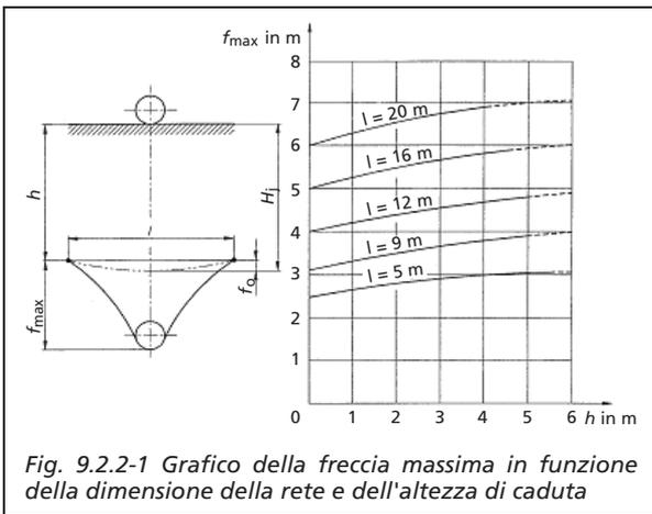
Fig. 9.2.2-1 Grafico della freccia massima in funzione della dimensione della rete e dell'altezza di caduta
