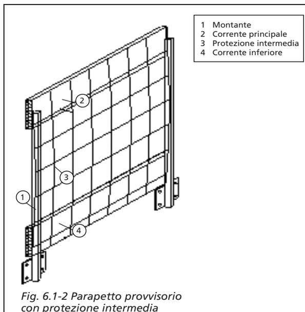
Fig. 6.1-2 Parapetto provvisorio con protezione intermedia
